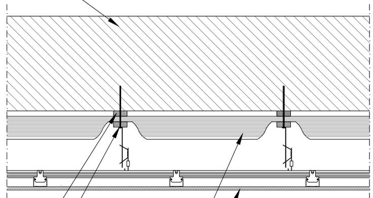
Cantinella in legno (prima lama d'aria microventilata)
